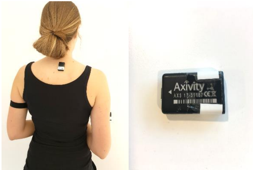
Figur 2. Inclinometer för mätning av arbetsställningar, 3,5 cm lång, 2,5 cm bred och 0,8 cm hög. Det sitter en mätare på höger överarm och en på bröstryggen. Här syns också armbandet för pulsmätning på vänster överarm.
